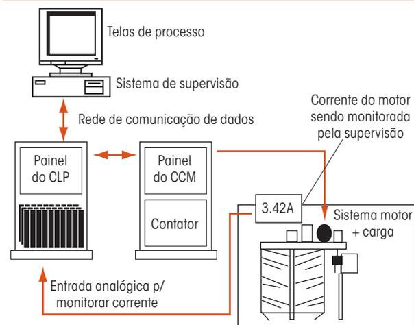
**Ilustração 1: Integração de um sistema automatizado, utilizando um supervisório**
