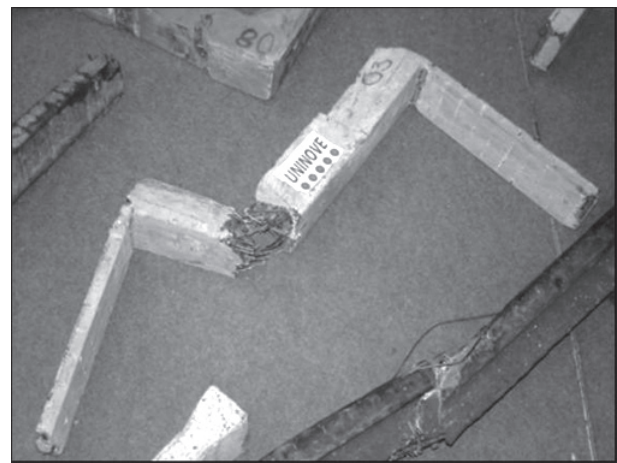
Fotografia 3: Pórticos que não resistiram ao impacto
