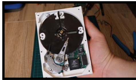
Figura 5 - Protótipo: um relógio montado com um disco rígido (HD de Computador)
